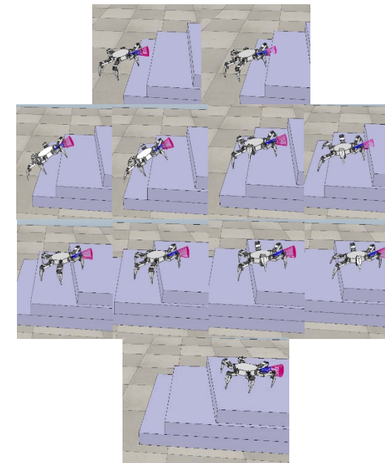
Rysunek 3.: Wspięcie się robota na pierwszej konfiguracji schodów
